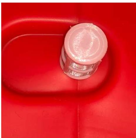
Fig. 6-4 – Dettaglio filtro interno per il pompaggio
