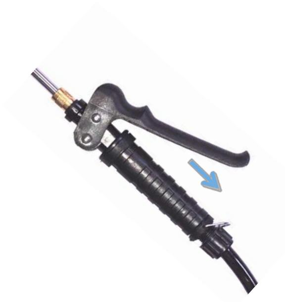
Fig. 7-3 – Dettaglio blocco a gancio disinserito
